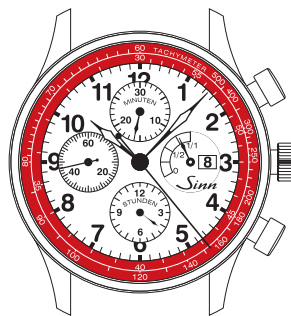
Tachymeterskala am Beispiel der 956 Klassik.
