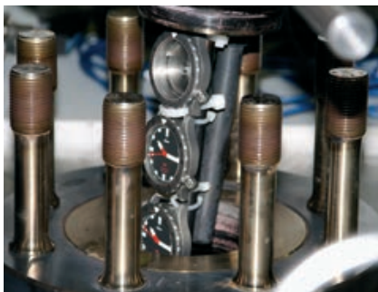
Zwei Modelle U1 sowie ein Gehäuse werden in den Druckbehälter abgesenkt.
