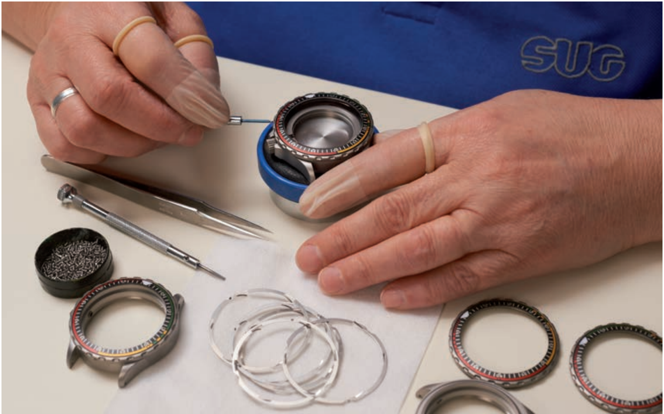
In der Endmontage werden die Einzelteile zu Komplettgehäusen montiert, wie hier beim EZM 7, dem Einsatzzeitmesser für die Feuerwehr.
