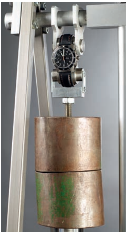
Testanlage zur Überprüfung der sicheren Befestigung des Bandsystems.
