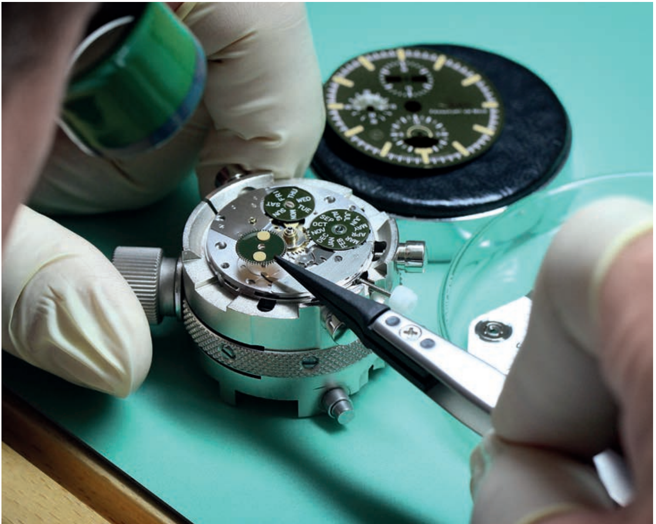
Präzisionsarbeit bis ins kleinste Detail: Auch beim Setzen der Mondscheibe der JAGDUHR 3006 ist höchste Konzentration gefragt.
