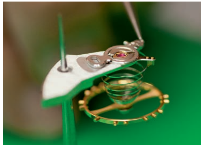
Die Unruh bildet das schlagende Herz einer mechanischen Armbanduhr.
