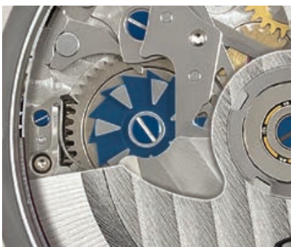
910 SRS: Detailansicht des komplexen, gebläuten Schaltrades. Es steuert bei diesem Chronographen die Start-, Stopp- und Rückstellfunktion.
