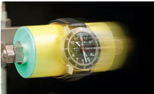
103 TI UTC IFR in einer Zentrifuge zur Überprüfung der G-Belastung. Es wird mit einer Belastung von 6 g getestet.
