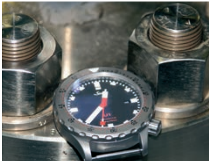
Druckbehälter-Verschraubung mit 36er Gewinde: Die U1 bestand mühelos die 100-bar-Prüfung. 1 bar = 100.000 Pascal.
