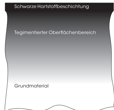
Schematischer Aufbau unserer Hartstoffschicht auf einer mit der TEGIMENT-Technologie gehärteten Oberfläche.
