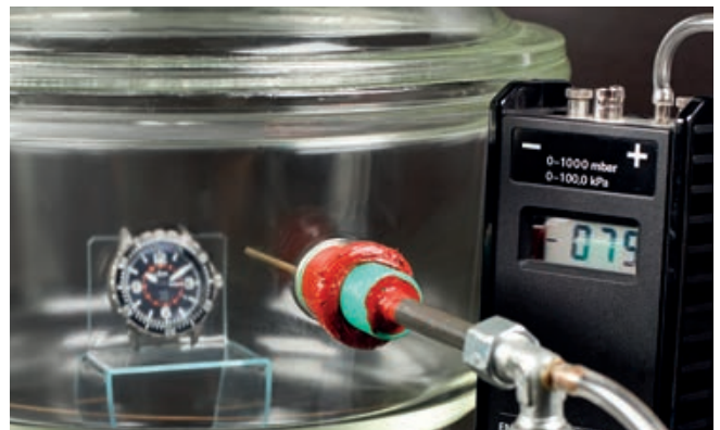
Differenzdruckprüfung in einem Vakuumexsikkator: Eine Fliegeruhr nach DIN 8330, wie die 857 UTC VFR, muss mehrtausendfache Druckwechselbelastungen aushalten.
