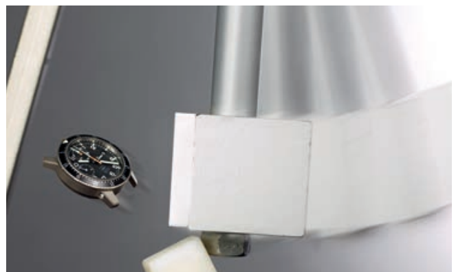
Testanlage zur Stoß- und Schlagsicherheitsprüfung. Hier im Test die 103 TI IFR.
