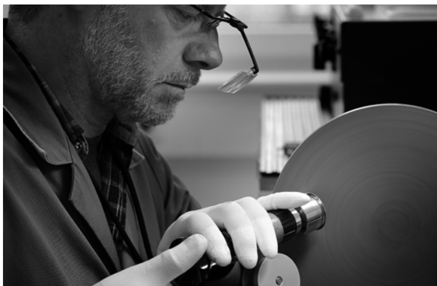
Auf Kundenwunsch: An einer Lapidiermaschine wird ein Gehäuse speziell bearbeitet.
