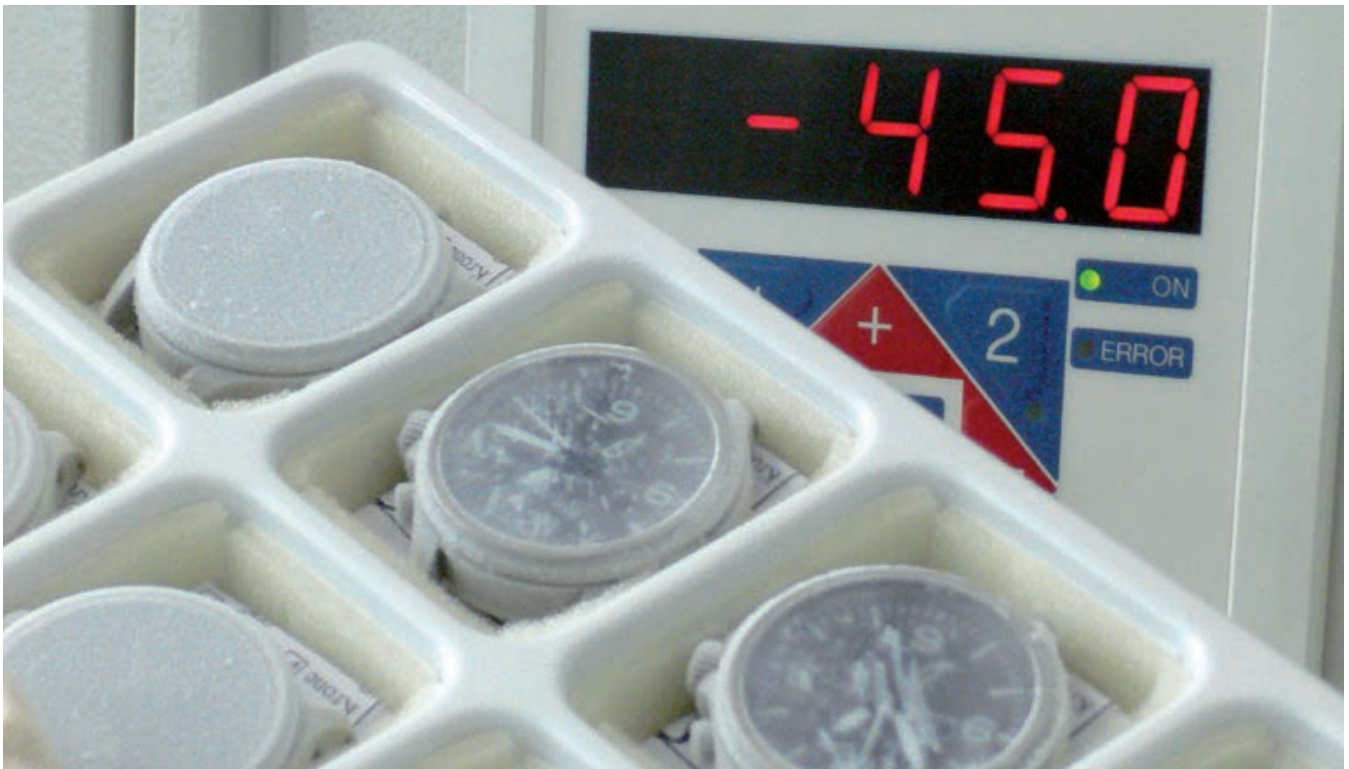
Einzelprüfung der Uhren im Temperaturschrank von -45^{\circ}\text{C} bis +80^{\circ}\text{C} .
