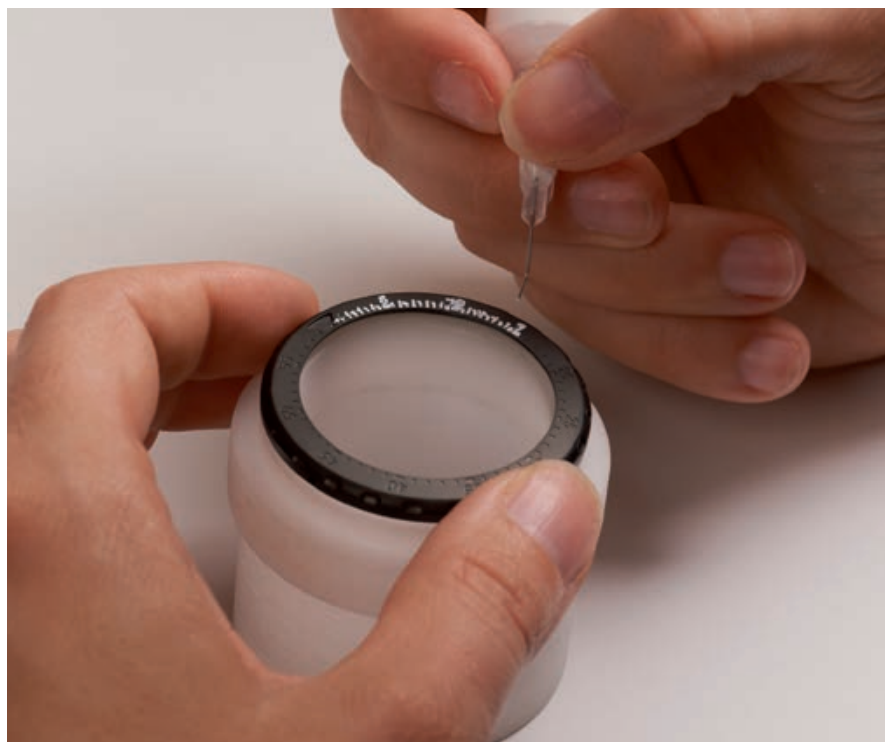
Mit gutem Auge und ruhiger Hand werden Ziffern und Indizes mit Spezialfarbe auf einen Taucherdrehring aufgebracht.
