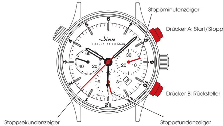
Die Frankfurter Finanzplatzuhr verfügt über einen Chronographen (Stoppuhr). Sie können mit ihm Zeitabschnitte bis zu 11 Stunden, 59 Minuten und 59 Sekunden messen bzw. festhalten. Der zentrale Stoppskundenzeiger und die kleinen Stoppszeiger für die Stunden und Minuten dienen der Zeitmessung mit dem Chronographen. Der Chronograph wird mit den beiden Drückern „A“ und „B“ bedient. Drücker „A“
