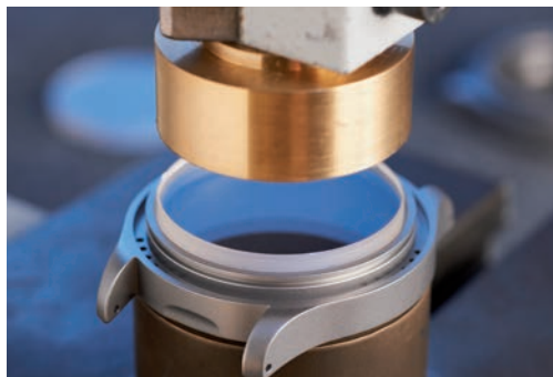
L'ajustement de la glace saphir nécessite une précision optimale.
