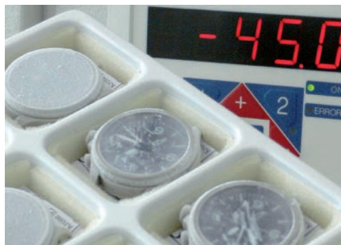
Test individuel des montres en chambre thermique à des températures comprises entre -45^{\circ}\text{C} et +80^{\circ}\text{C} .
