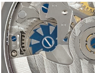
Vue détaillée de la roue à cliquet complexe bleutée. Elle commande la fonction démarrage, arrêt et réinitialisation de ce chronographe.
