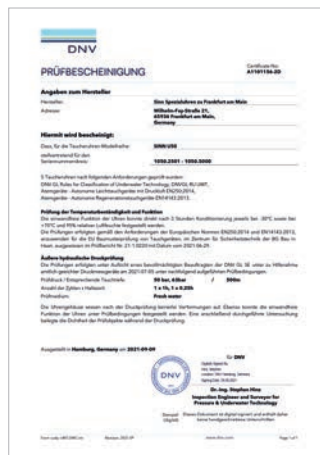
Certificats de la Germanischer Lloyd (aujourd'hui DNV) pour les séries U1 et U50 attestant la réussite des essais de résistance à la pression (ci-dessus) ainsi que la conformité aux normes européennes EN250 et EN14143 sur les appareils de plongée. Les deux certificats présentés ici correspondent aux séries certifiées 206, T1, T2, T50, U2, U200, U212, UX, UX GSG9, U1000, EZM 3, EZM 13.1 et EZM 13.
