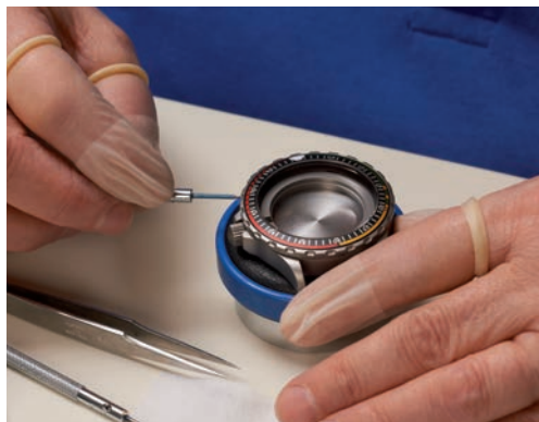
Lors de la phase finale, les différents composants sont assemblés pour former la boîte. On voit ici le compteur de mission EZM 7 spécialement conçu pour les sapeurs-pompiers.
