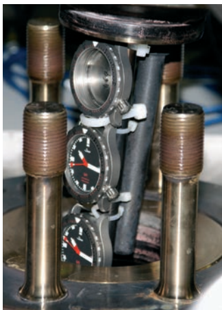
Immersion de deux modèles U1 et d'une boîte dans l'autoclave.
