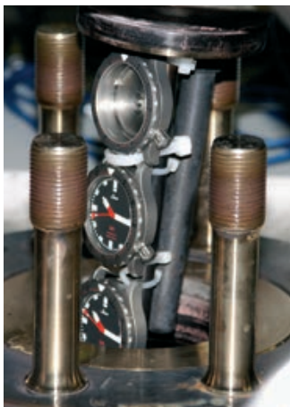
2個のU1モデルと1個のケースが圧力槽に入れます。
