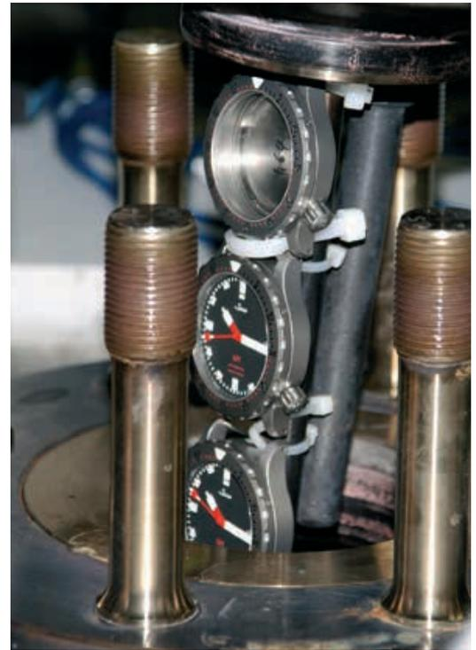
Alle technischen Angaben zu unseren Uhren werden durch Prüfungen belegt. Zwei Uhren sowie ein Gehäuse der Modellreihe U1 werden in den Druckbehälter unserer Messanlage abgesenkt. Eigens für die Zertifizierung durch den weltgrößten Sicherheitsklassifizierer der Schifffahrt DNV GL (vormals Germanischer Lloyd, Hamburg) haben wir diese Messanlage konstruiert.
