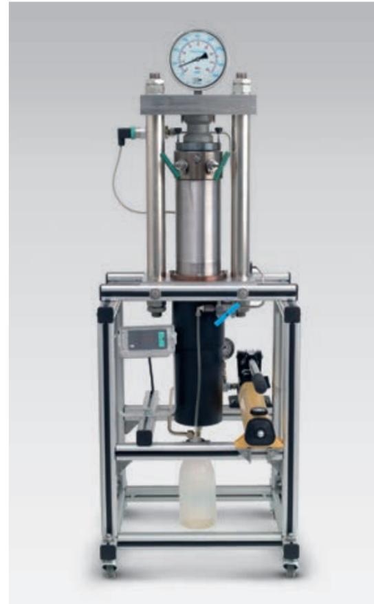
Alle technischen Angaben zu unseren Uhren werden durch Prüfungen belegt. Eigens für die Zertifizierung der Druckfestigkeit unserer Taucheruhren durch den weltgrößten Sicherheitsklassifizierer der Schifffahrt DNV GL (vormals Germanischer Lloyd, Hamburg) haben wir diese Messanlage konstruiert.
