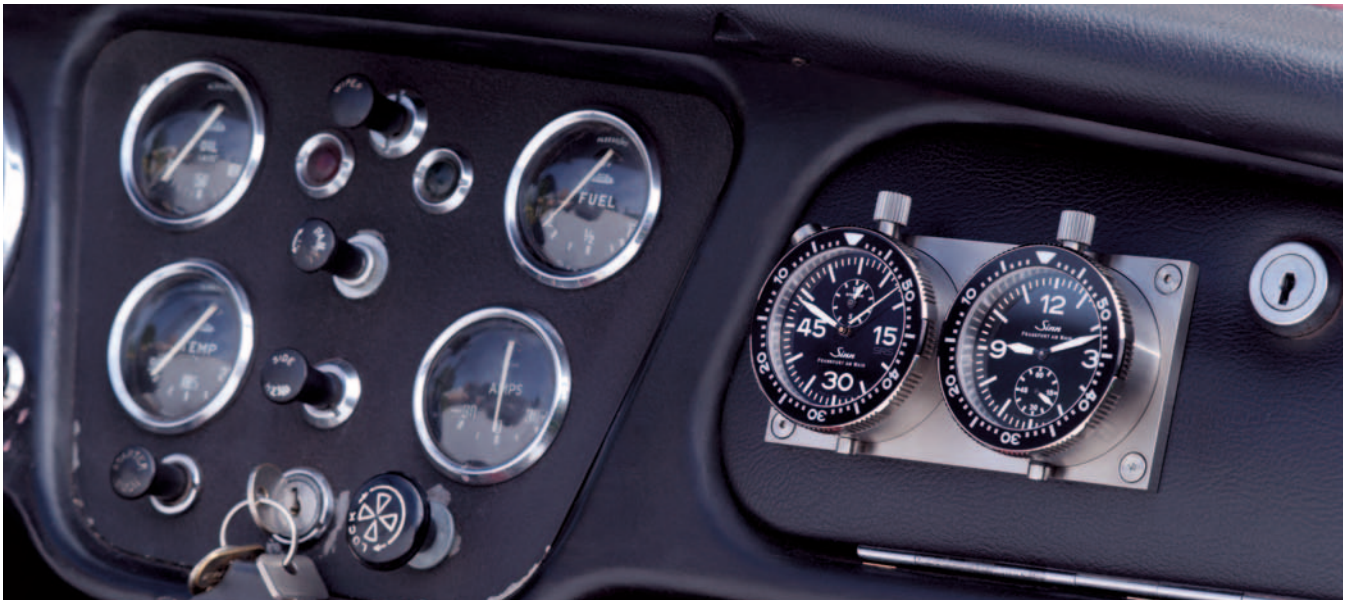
Herausnehmbare Borduhren auf der fest verschraubten Montageplatte.
