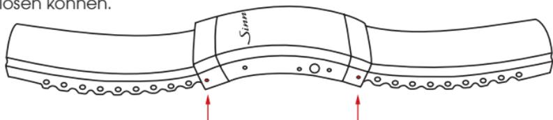
2. Durchtrennen Sie das abgelöste Silikonarmband mit einem Messer oder einer Schere mittig zwischen zwei Metallstiften. Die Kürzung des Bandes sollte symmetrisch und schrittweise, von der Schließe aus beginnend, bis zur gewünschten Bandlänge erfolgen. Probieren Sie das Band vorsorglich zwischendurch noch einmal an. Eine beidseitige Kürzung von je einem Metallstift entspricht einer Minderung des Gesamtumfanges um 10 mm, eine einseitige Längenreduzierung um 5 mm.
