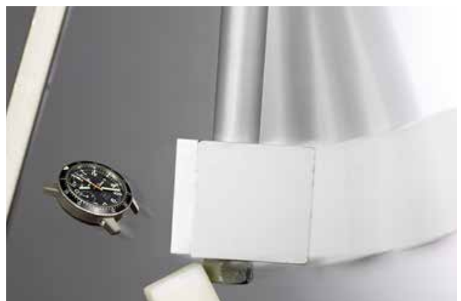
Testanlage zur Stoß- und Schlagsicherheitsprüfung. Hier im Test die 103 Ti IFR.
