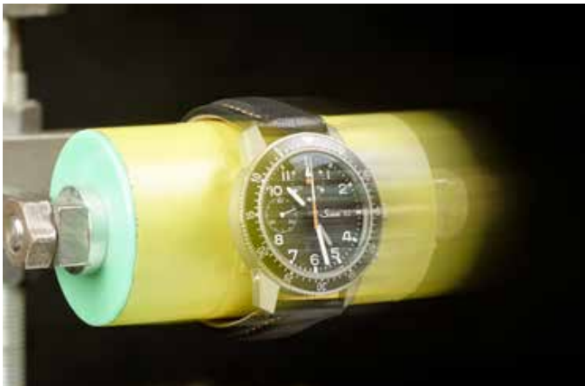
103 Ti UTC IFR in einer Zentrifuge zur Überprüfung der G-Belastung. Es wird mit einer Belastung von 6 g getestet.
