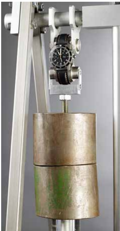
Testanlage zur Überprüfung der sicheren Befestigung des Bandsystems.
