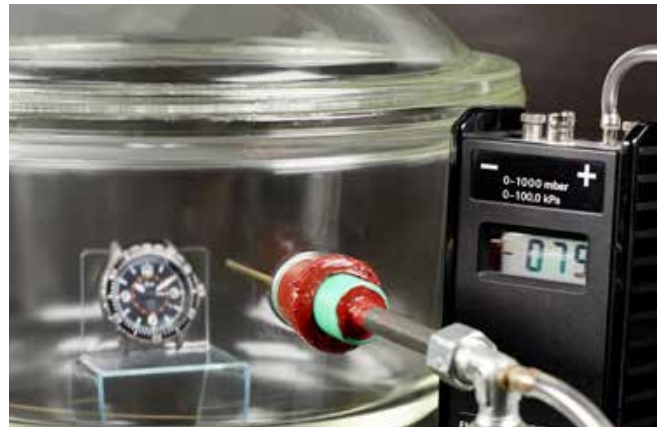
Differenzdruckprüfung in einem Vakuumexsikkator: Eine Fliegeruhr nach DIN 8330, wie die 857 UTC VFR, muss mehrtausendfache Druckwechselbelastungen aushalten.
