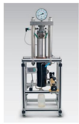
Alle technischen Angaben zu unseren Uhren werden durch Prüfungen belegt. Eigens für die Zertifizierung der Druckfestigkeit unserer Taucheruhren durch den weitgrößten Sicherheitsklassifizierer der Schifffahrt DNV (vormals Germanischer Lloyd, Hamburg) haben wir diese Messanlage konstruiert.
