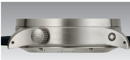
Der Gehäuseboden der 900 FLIEGER ist aus nickelfreiem Edelstahl. Die Seitenansicht zeigt die eingeschraubte Trockenkapsel, die gleichzeitig als Feuchtigkeitsindikator dient: weiß = ungesättigt; blau = gesättigt. (Abb.: 1:1)
